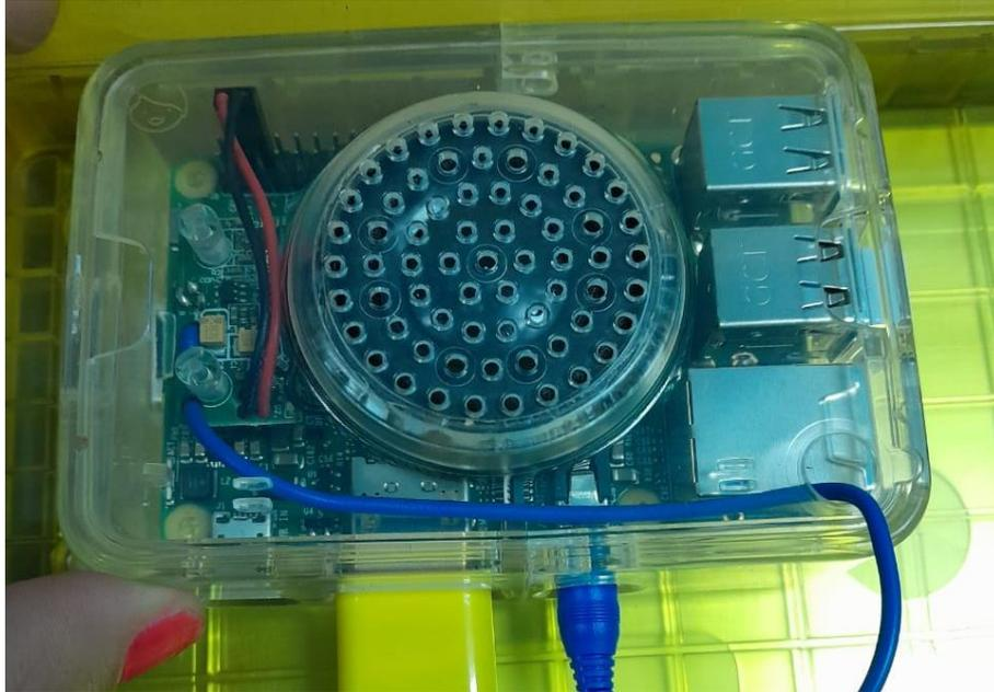
Debemos conectar el transmisor del teclado a un puerto USB, seguidamente, vamos a conectar el altavoz, los conectores de HDMI, luego una de Los otros dos conectores USB y se deberán encender las luces.
